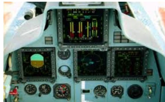
Su-30MKI 機上のディスプレイシステム CMM + Microflexを使用
