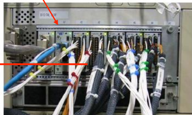
図 8: 改良した FPGA 制御ボード (上) と、実装した LLRF システム (下)
