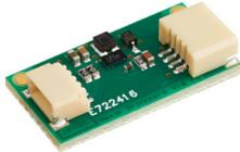
A-シリーズ、C-S-シリーズ、C-u-シリーズ用にMaximドライバーICと4ピンのFPCコネクタを搭載したドライバーボードです。DC電源供給とI<sup>2</sup>C通信用にJSTの4ピンコネクタが付いています。マイコンやFPGAやDSP等から直接液体レンズを高速に駆動するために設計されました。ボードにはケーブル付きJSTコネクタが付属します。
