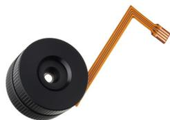
VHD-0xシリーズはA-シリーズに対応し、FPC-A- x と組合わせて使用します。Drivboardに直接接続出来ます。外周部にM4のねじ切りがあり標準のM4マウント機器にホルダーを固定します。ホルダーの後ろ側に直径14mmのくぼみがありコンパクトな対物レンズに簡単に組込み出来ます。
