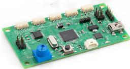
USBからRS232-12V/RS232-3.3V/I<sup>2</sup>C/SPIに変換するボードです。USBケーブルでPCと接続して、C-Cモジュールをボードに接続します。FocusLab Cを使用して全てのC-Cバージョンと直接通信することが可能です。ポテンショメータでコンピュータを介さずにC-Cの電圧を直接制御することも可能です。
